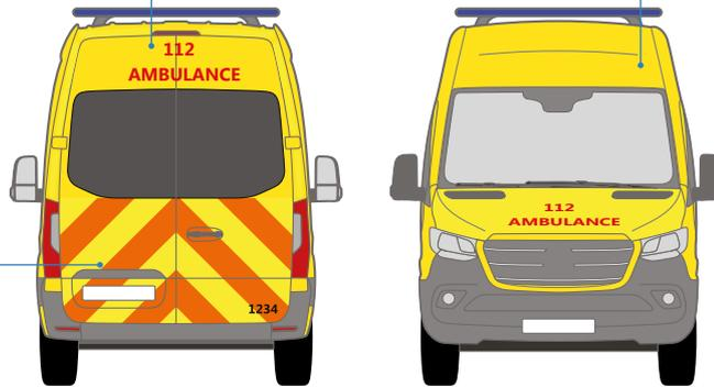
Le marquage Battenburg est constitué alternativement de carreaux microprismatiques rétro réfléchissants de couleur jaune/vert fluorescent et des marquages de contour sur les côtés
